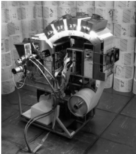
Figure 7. Bull, maquette large THV 300 fpm, 1986. Les rouleaux de papier imprimés lors d'un essai d'endurance de 100 H sont empilés au fond.
